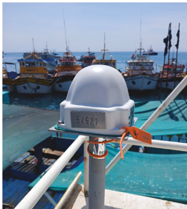
Uma antena VMS instalada em uma embarcação Peruana. A unidade é fixada ao suporte de montagem com um lacre laranja inviolável para garantir a integridade dos dados e a conformidade.
