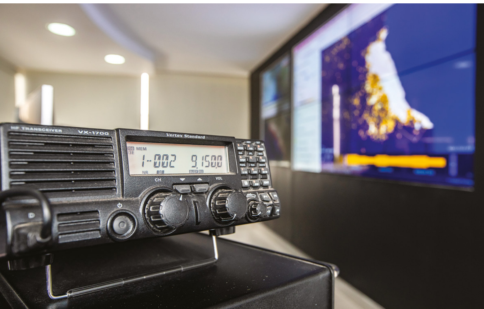
Dentro de um centro de monitoramento e controle da pesca, um rádio marítimo de alta frequência fica pronto para comunicação direta com as embarcações. Ao fundo, o mapa do Global Fishing Watch oferece uma visão clara da presença de embarcações costeiras por meio dos dados do VMS. © Global Fishing Watch
