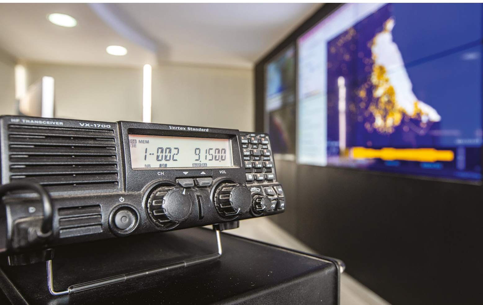
En el interior de un centro de seguimiento y control pesquero, una radio marina de alta frecuencia está preparada para la comunicación directa con los buques. Al fondo, el mapa de Global Fishing Watch ofrece una imagen clara de la presencia de buques en la costa utilizando datos del VMS. © Global Fishing Watch
