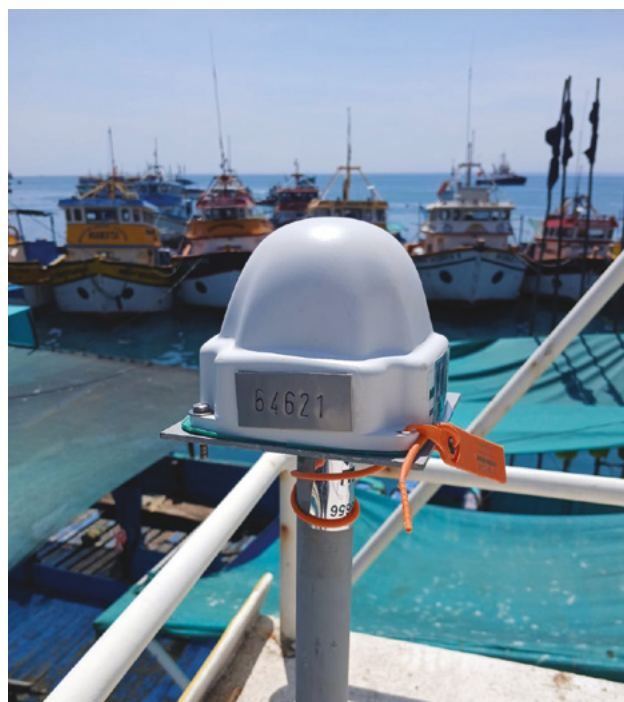
Un terminal satelital VMS tipo B montado en una embarcación peruana. La unidad está asegurada al soporte de montaje con un precinto de seguridad naranja para garantizar la integridad de los datos y el cumplimiento normativo. © SISESAT-PRODUCE-PERU
