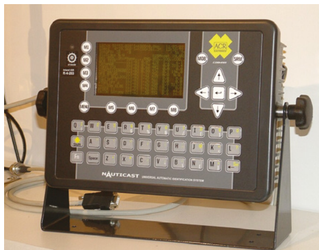
El transpondedor AIS a bordo cuenta con una pantalla integrada y un teclado para la introducción manual de datos. © Wikimedia Commons
