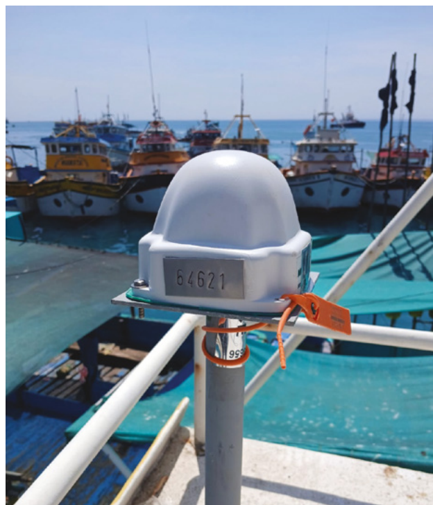
Un terminal satellite VMS de type B monté sur un navire péruvien. L'unité est fixée au support de montage avec un scellé de sécurité orange pour garantir l'intégrité des données et la conformité. © SISESAT-PRODUCE-PERU
